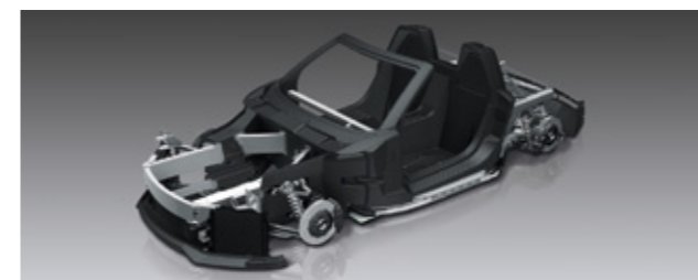
Das Roding CFK-Chassis mit AH 140 im Vakuuminfusionsverfahren hergestellt
