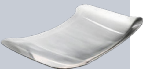
Nickelschalenwerkzeug gefertigt im Galvanobad auf ebablock® P 185
