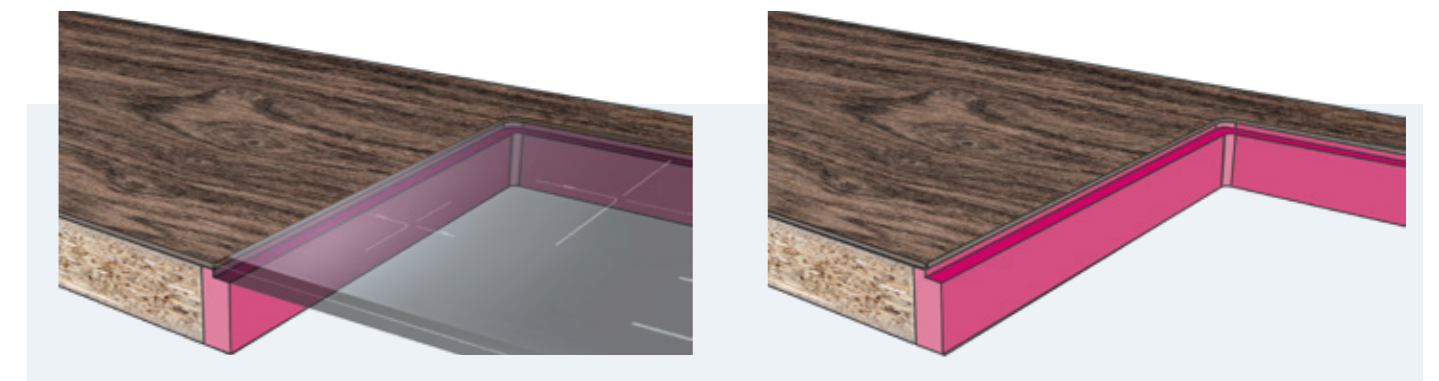
Einbauten mit Gießharzrahmen mit Material aus der 500er Serie vergossen.
